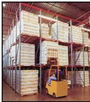
Figura N°4 Estantería de almacenamiento acumulativo – vista de lateral
