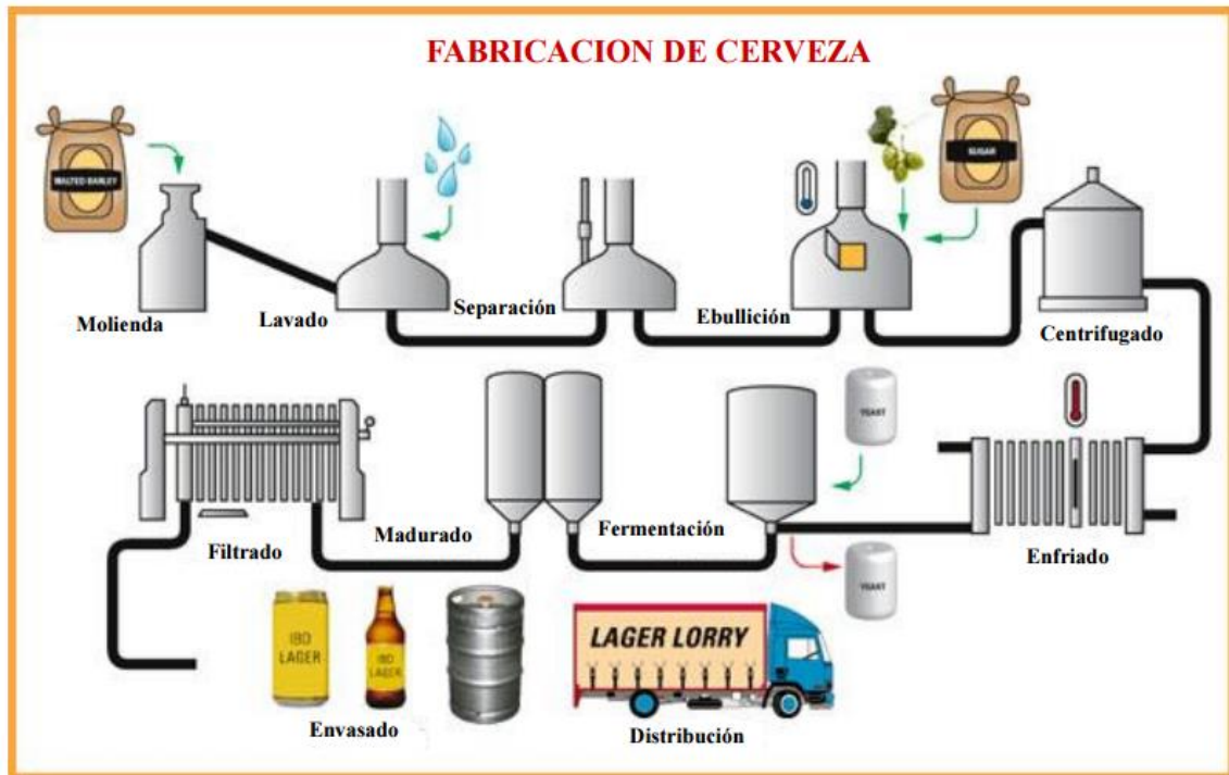
Figura 10: Diagrama de flujo del proceso de fabricación de cerveza.
