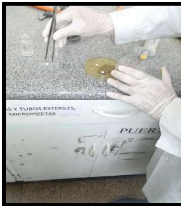
FIGURA 26: Colocación de los discos en las placas
