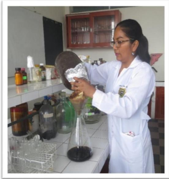
Foto N°08 El proceso del Vaciado del extracto etanólico al matraz del Rotavapor para luego continuar con el procedimiento correspondiente.
