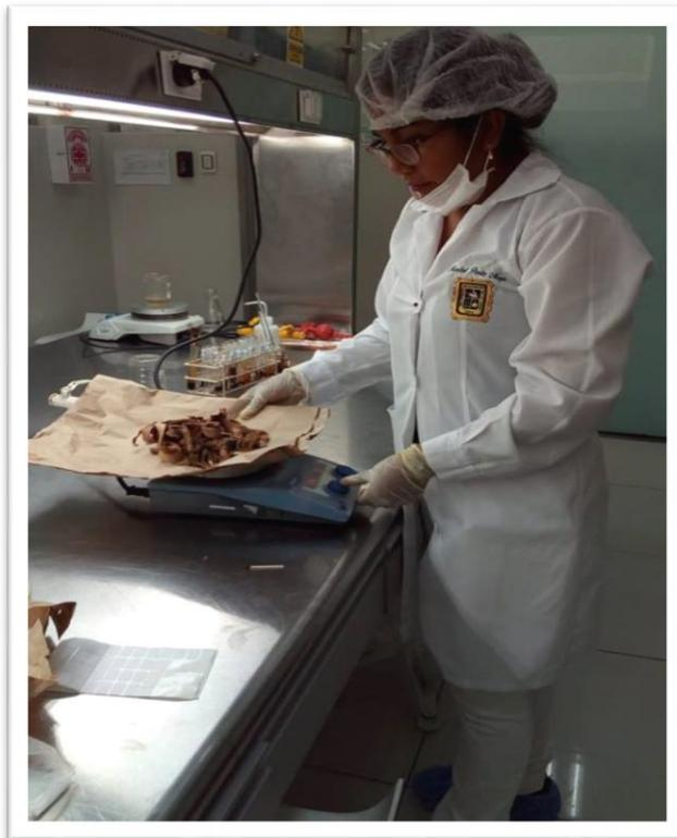
A. Foto N° 06 El Macerado del Extracto etanólico de la corteza bellaco caspi (*Himatanthus tarapotensis*) fue triturado y molido de forma mecánica (molivo), y colocada en un frasco ámbar de boca ancha, para luego ser cubierto por etanol 96 °C por un periodo de 15 días y con agitación de cada 12 horas, protegido de la luz y calor.
