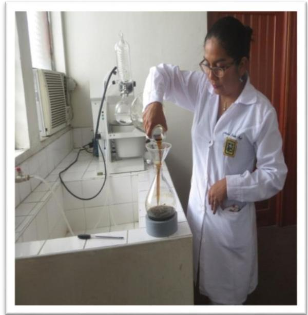
Foto N°09 Obtención del extracto etanólico del bellaco caspi (*Himatanthus tarapotensis*) en el instrumento del Rotavapor a presión reducida.
