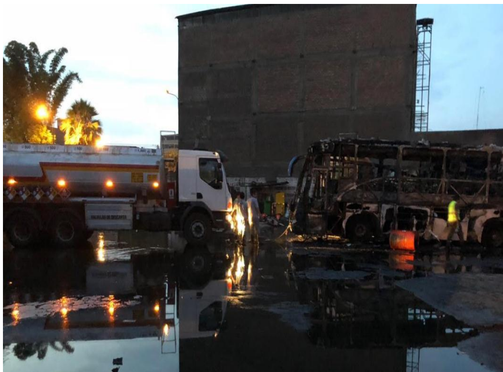
Fig. 13 Activos perdidos después de un incendio por falla del sistema de energía eléctrica.
