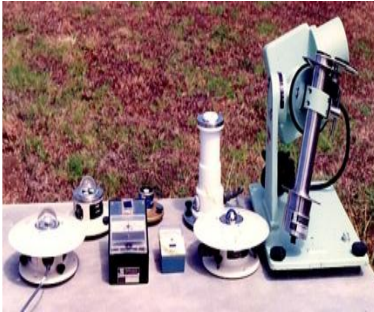
Fig. 1. Instrumentos para medir diferentes tipos de Radiación solar- Global, Directa y Ultra Violeta.
