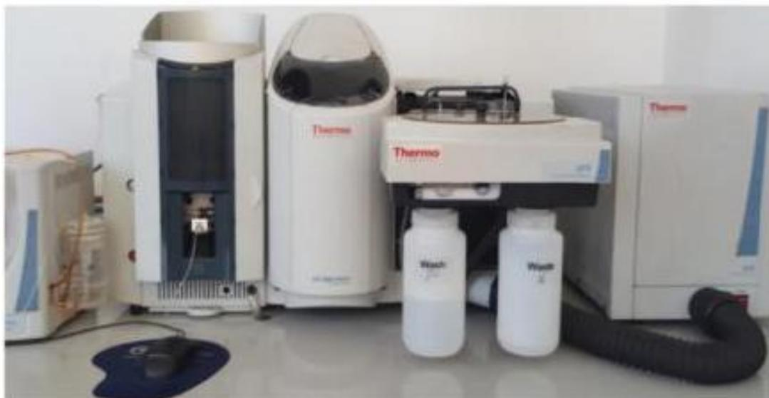
**Figura17: Espectrómetro de absorción atómica marca Thermo Scientific serie iCE 3000, acoplado a un Sistema de Vapor VP
