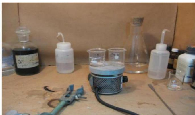
**Figura 30,31,32,33: Preparación estándar para la determinación de As y Hg .
