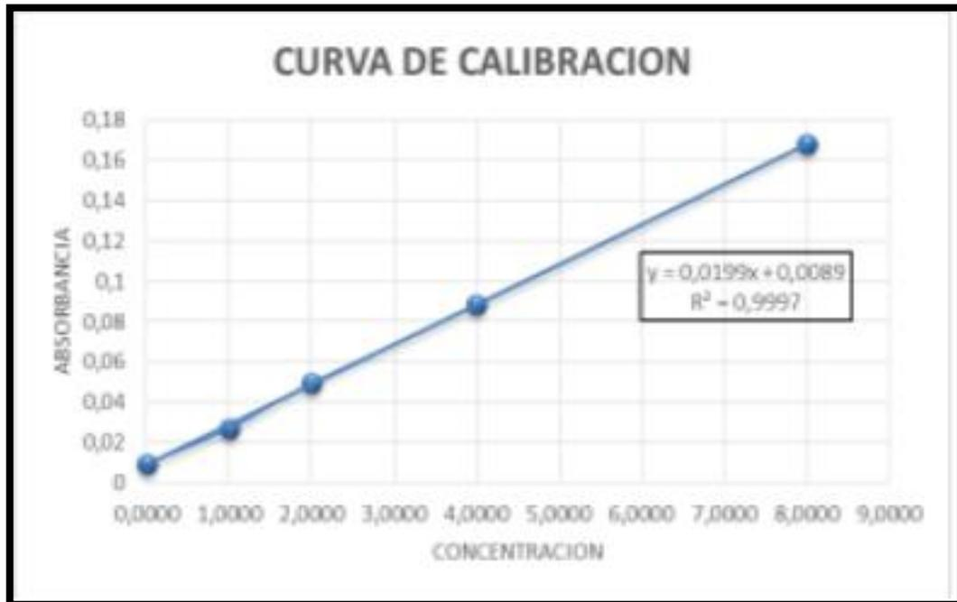
**Figura 12:** Curva de calibración para arsénico.
