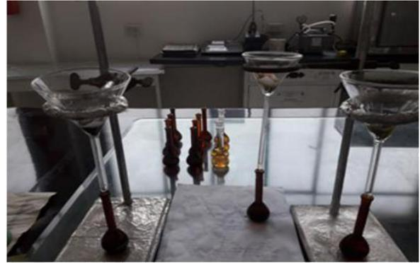
Preparación del caldo LST y de las muestras y medir el PH con el potenciómetro el valor de la medición debe estar (6.9 – 7.3) y añadir una cantidad de caldo preparado en 10 tubos de ensayo con tapa rosca
