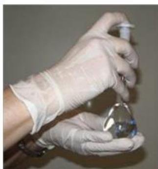
Se trasvasó en una fiola de 100 ml. Se enrazó con agua ultra pura para obtener una concentración de 1000 ug/L
