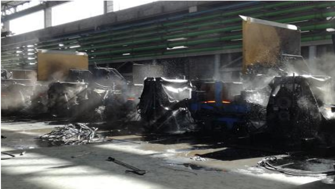
Figura 23 Vapores inherentes al proceso de laminado
