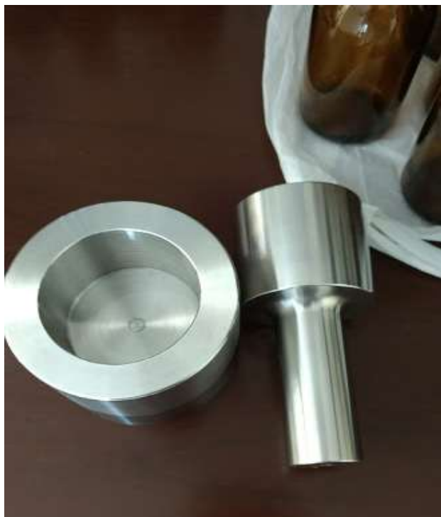
Fig. 11 Triturar los frascos en mortero de acero
