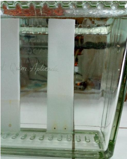
FIG.10 Se realizó el sembrado de la muestra y se colocó en la cuba cromatográfica con solvente cloroformo y metanol (3:1), se espera la corrida total del solvente.
