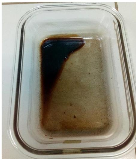
FIG. 3 Después de dos días se obtuvo el extracto seco. Peso del recipiente solo: 387.5 g. Peso de recipiente con muestra: 393.8 g
