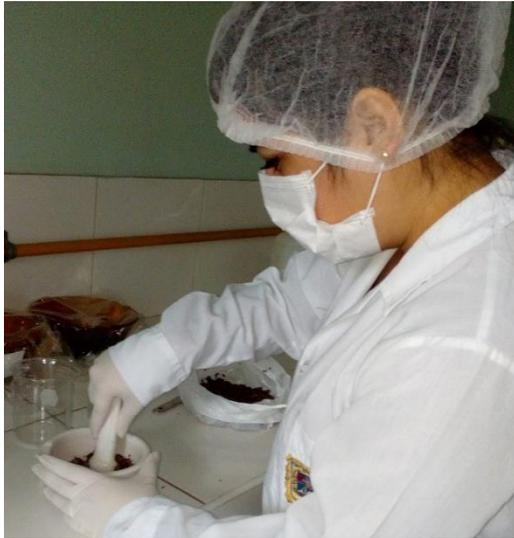
FIG.21 Se tritura la cáscara de plátano previamente lavada en un mortero, se descarta el fruto, se divide 2gr, 4gr, y 10 gr respectivamente para separarlo en diferentes concentraciones.
