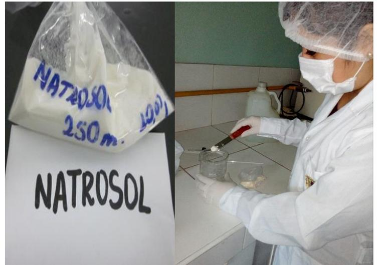
FIG. 22 En un beaker se agrega 1 gr. de Natrosol, Metilparabeno 0.5 gr. y se diluye con 99 ml de agua destilada, se agita hasta dilución.
