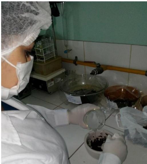
FIG. 23 El contenido del beaker se mezcla con la cáscara triturada.
