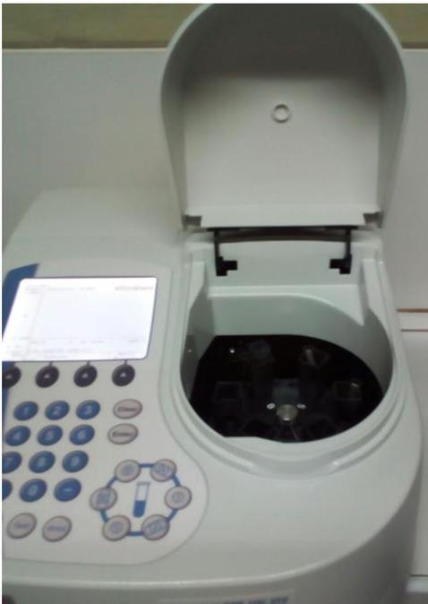
FIG.15 Se colocó alcohol de 96° a la celda para utilizarlo como blanco y colocar los rangos exactos para la medición de los viales.
