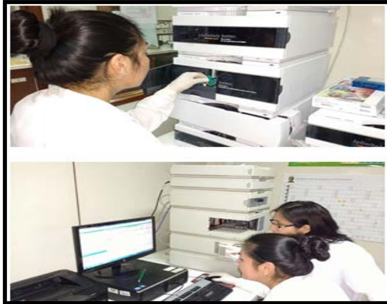
Figura 53: Fotos de los tesistas poniendo las muestras en el cromatógrafo líquido (HPLC)
