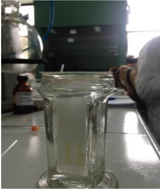
Figura N° 5. Cubeta de cromatografía con las placas de silica gel
