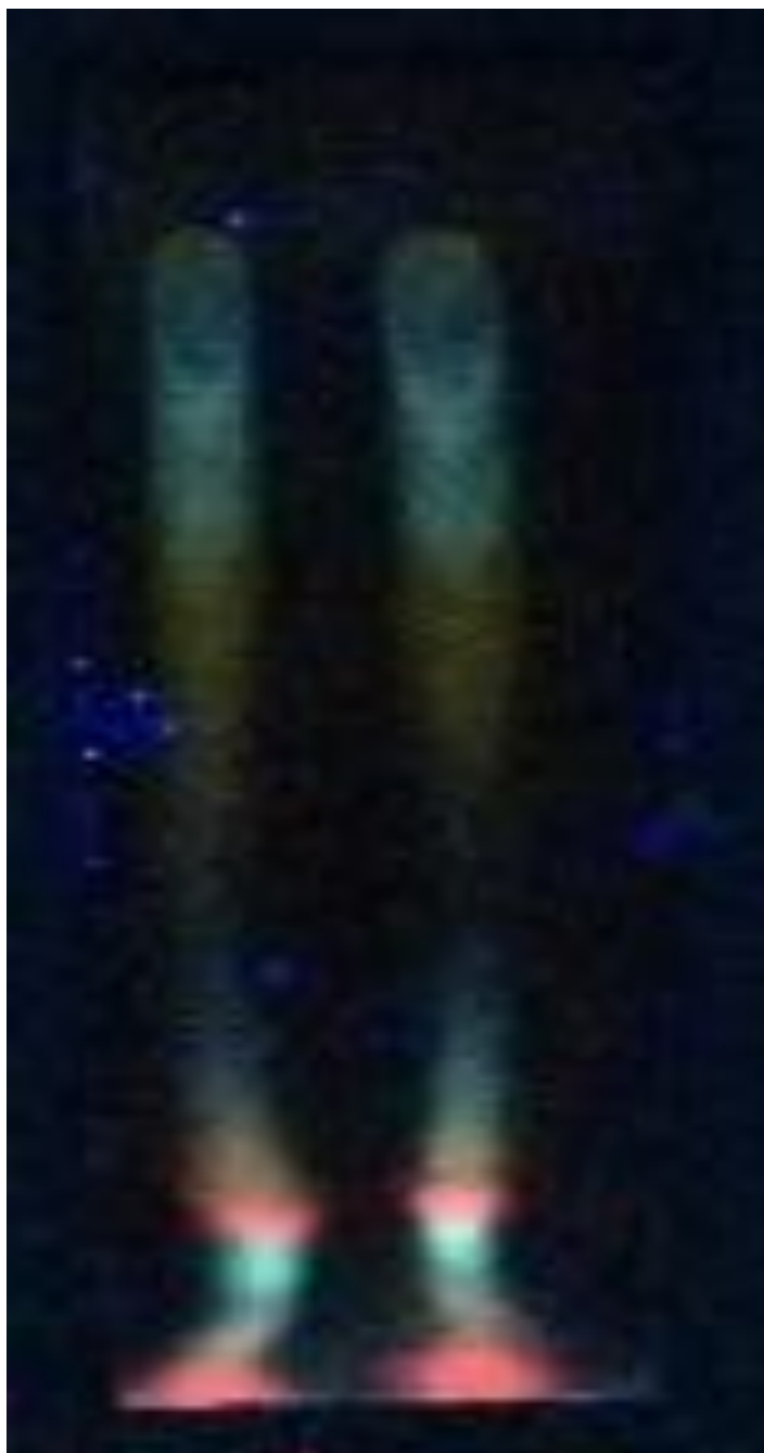
Figura N° 7. Lámina que contiene más de 21 componentes químicos detectados por cromatografía en capa fina
