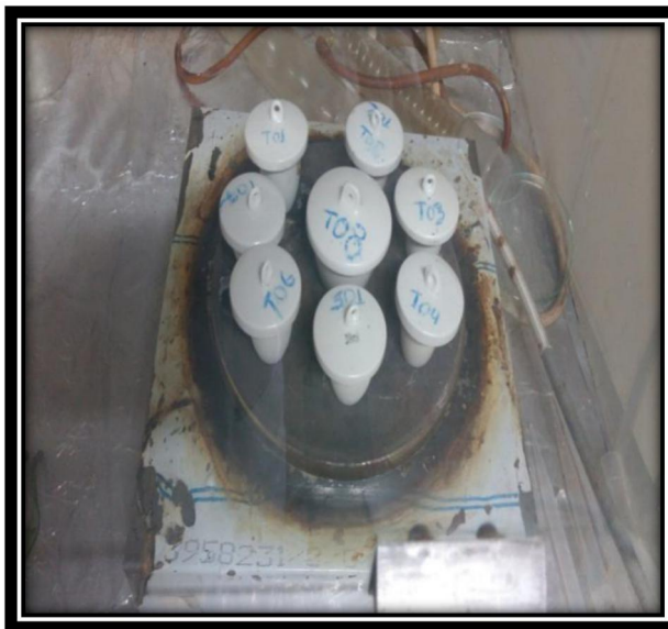
Figura N° 20 y Figura N° 21. Muestra de t mpera en un crisol, colocado en una cocinilla hasta la aparici n de cenizas.
