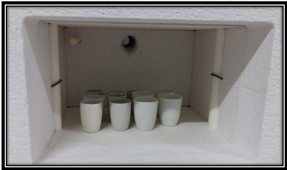
Figura N° 22. La muestra de cenizas colocadas en una mufla a 700 ° C por 4 h.
