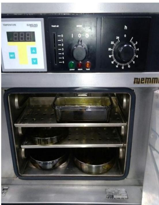
**Figura 3:** Secado del extracto en estufa
