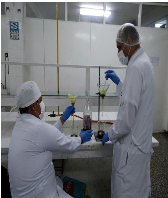
**Figura 1:** Filtrado del macerado hidroalcohólico
