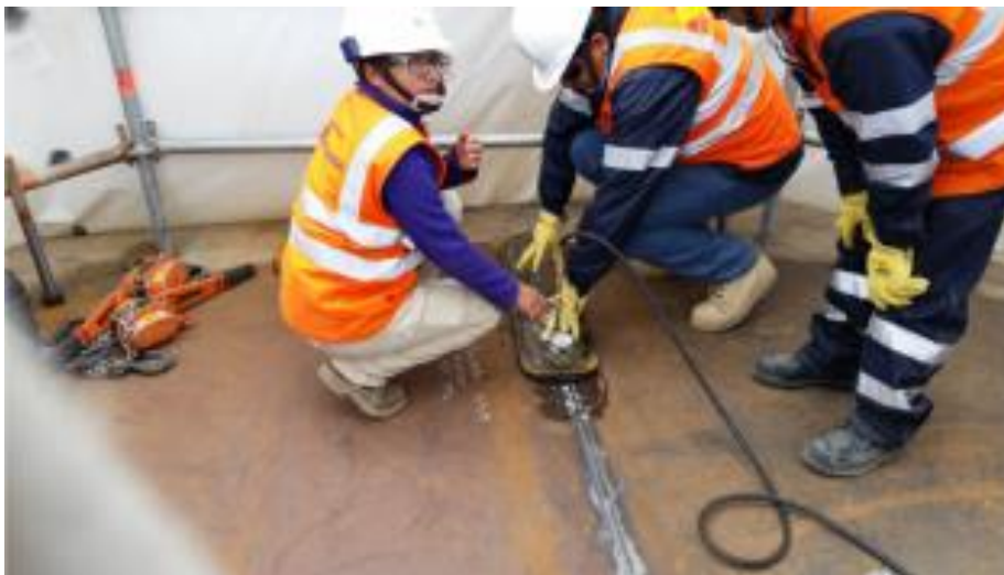
GRAFICA 9: Prueba de vacío: Se requiere equipo de prueba de vacío y personal calificado
