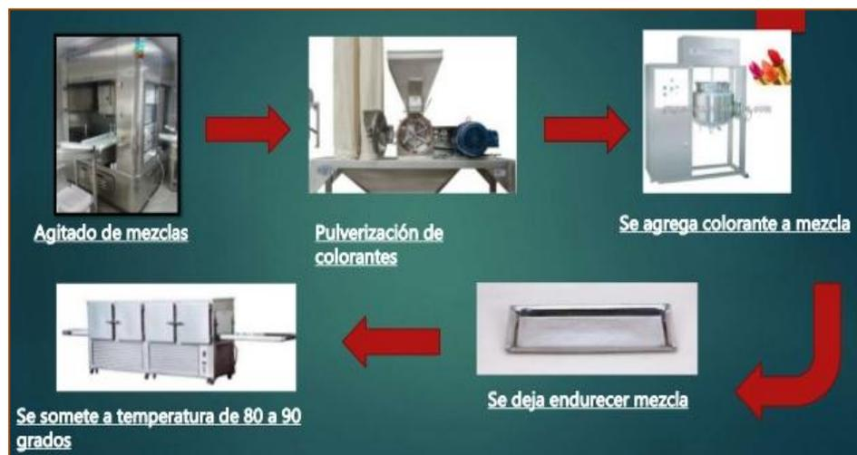
Figura N° 2: Proceso de fabricación de los labiales en barra
