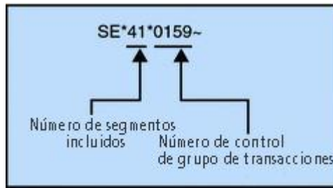
Figura 14. Ejemplo de un conjunto de transacciones rastreo [Fuente: Sun B2B Suite ASC X12 Protocol Manager User's Guide, 2010, adaptación propia]
