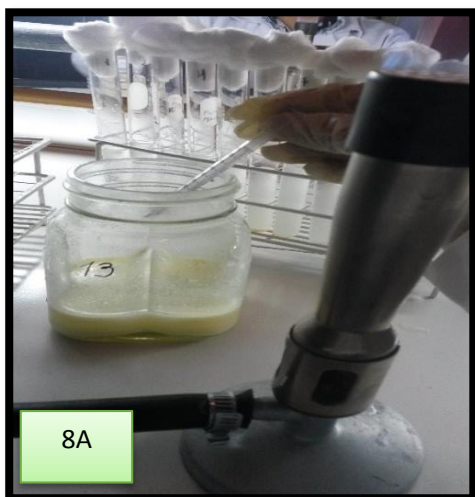
FIGURA 7: Mezclar y homogenizar la muestra
