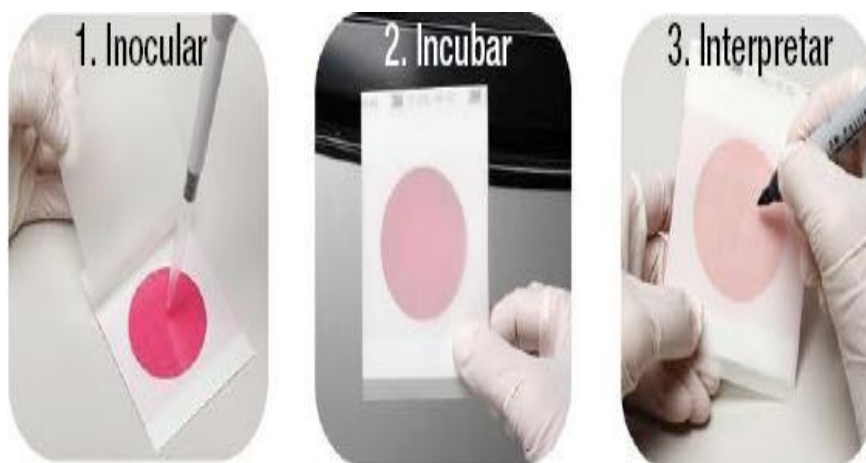
Figura N° 2: Pasos para recuento de microorganismos en placas Petrifilm™
