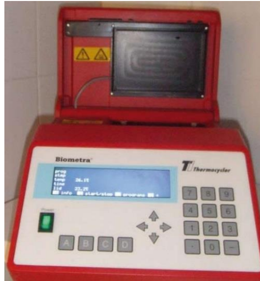
Figura 8. Programador de tiempos y temperaturas para realizar los ciclos de la amplificación por PCR (Javier B, Roger A, Adriana J, Adolfo C. Diagnostico microbiológico: su importancia en el tratamiento y pronostico periodontal. Rev Fac Odont Univ Ant 2003; 14 (2): 41 – 50)
